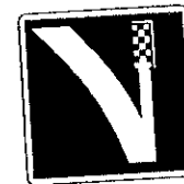
C26a Voie de détresse à droite
