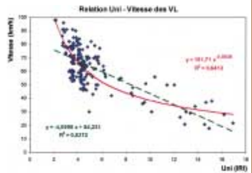
Fig.10/11. Sur ces graphiques figurent deux courbes de tendance : une régression linéaire et une régression en puissance (la loi retenue pour HDM est du type Vitesse = a*Uni-1).
