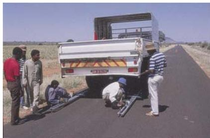
La mesure de la capacité portante avec des poutres Benkelman.
