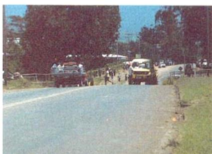
Mauvaise visibilité à cause d'une courbe concave cachée - une cause potentielle d'accidents.
