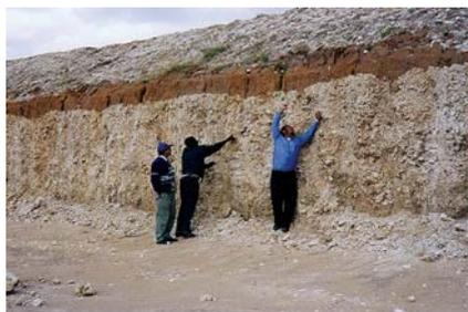
*Une croûte calcaire se trouvant dans la nature sous une couche mince de terrains de couverture.*
