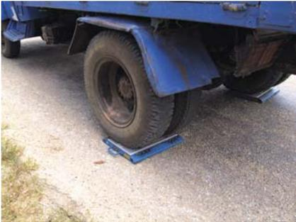
Mesure de la charge sur l'essieu arrière avec une bascule portative.
