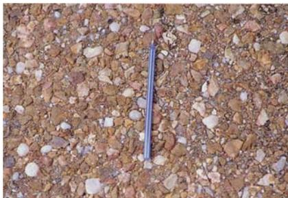
Du gravier criblé utilisé comme agrégat de revêtement dans un enduit Otta.
