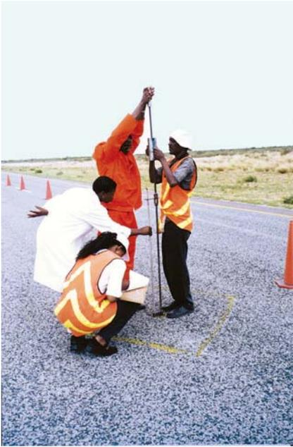
L'essai PDC en cours d'exécution.
