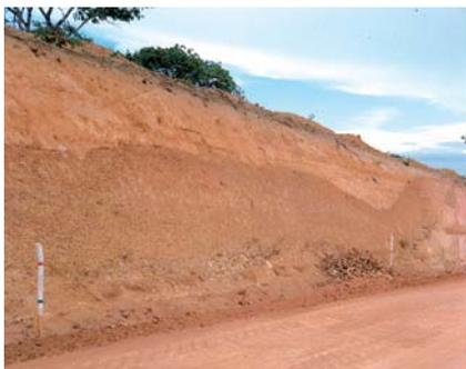
*La latérite est un exemple typique d'un matériau "non classique" qui a été utilisé dans la construction des RRFVC, malgré le fait qu'il ne conforme pas aux exigences traditionnelles de granulométrie, résistance et plasticité.*
