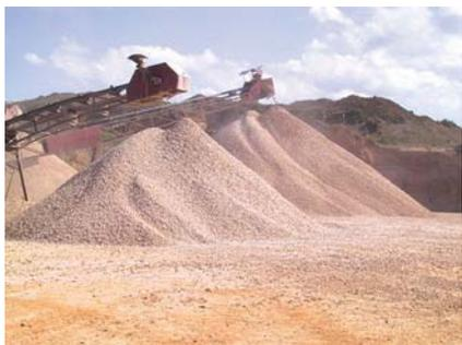
La pierre à chaux concassé est un matériau typique "classique" produit par le concassage des roches en masses à une gradation définie.
