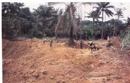
La latérite nodulaire brute utilisée dans la construction des RRFVC.
