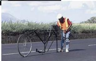
On peut mesurer la rugosité en utilisant des dispositifs de mesure rapide ou lente, tels que l'Intégrateur de Chocs ou le dispositif Merlin.
