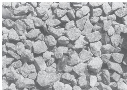
Des gravillons cubiques sont essentiels afin de réaliser une bonne imbrication des grains dans des enduits à gravillons.
