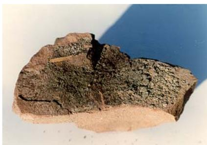
Un échantillon de basalte altéré et décomposé, avec des minéraux argileux altérés dans les vésicules et cavités du rocher.
