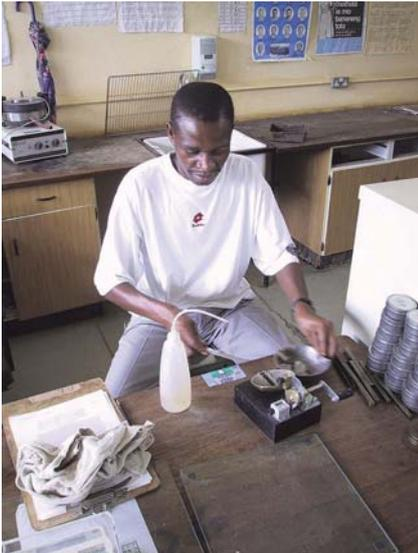
Le dispositif de limite de liquidité employé pour la détermination de l'Indice de Plasticité d'un sol.
