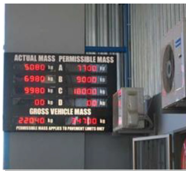
Digital display of actual and permissible masses
